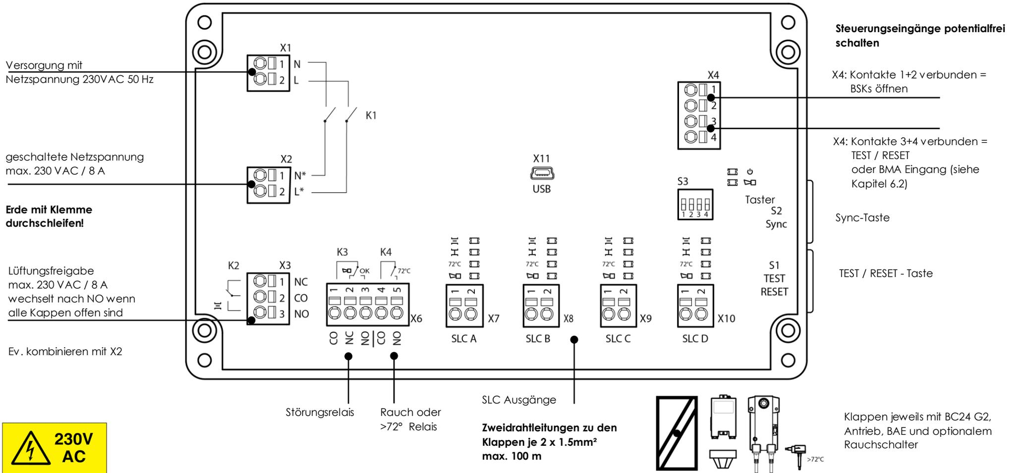
**Der Anschluss von 230 VAC an X1 und X2 darf nur durch qualifiziertes Fachpersonal erfolgen! Das Gerät ist mit einem 13 A Sicherungsautomaten abzusichern.**
