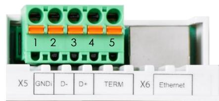
Protocolli supportati: Modbus RTU e BACnet MS/TP
