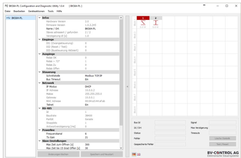
La funzione principale è l'indirizzamento selettivo delle utenze. Essa è accessibile tramite **Tools -> Indirizzamento Slave...**
