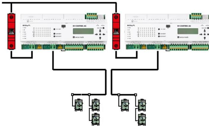
2. Alimentare il primo master ed eseguire la messa in funzione Powerline con il **canale standard 6**
