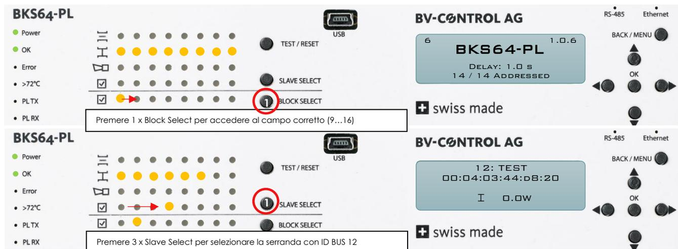
Se la serranda è selezionata, sul display LCD è descritto il relativo stato incl. la potenza assorbita. Premendo il tasto **TEST/RESET** è possibile confermare gli errori o avviare un test automatico.
