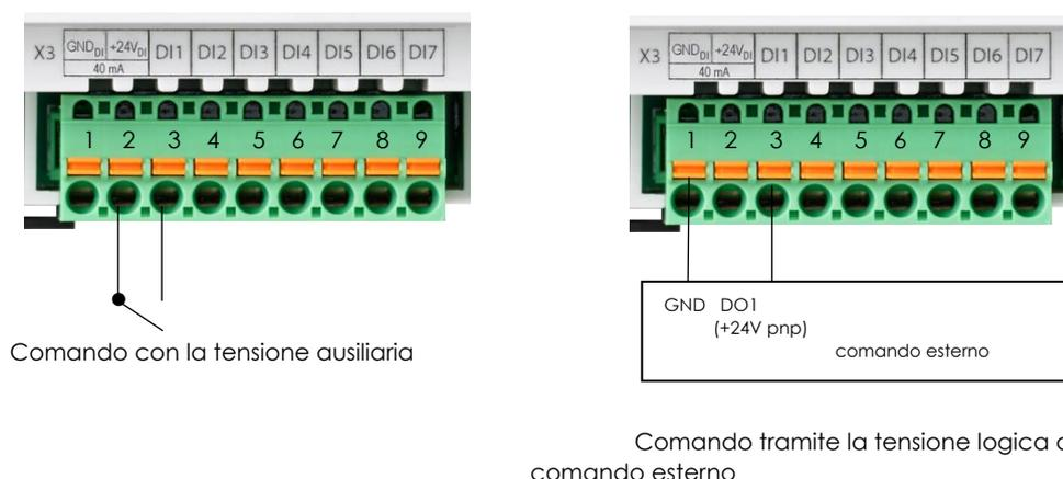
**Nota:** Se il segnale di comando (DI1) viene collegato tramite il relè di allarme incendio (X4.4/X4.5), tutte le serrande si chiudono quando viene attivato il rilevatore di fumo o la termocoppia di una serranda.
