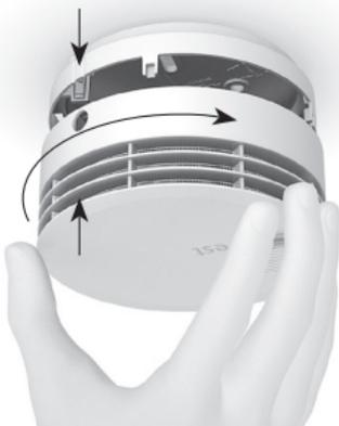
Für die Montage mit 2 Schrauben den Sockel an die Decke halten, um ihn festzuschrauben. Die Schrauben dafür durch die beiden Langlöcher führen. Das Fixierpad<sup>1</sup> ist bei der 2-Lochmontage nicht nötig.
